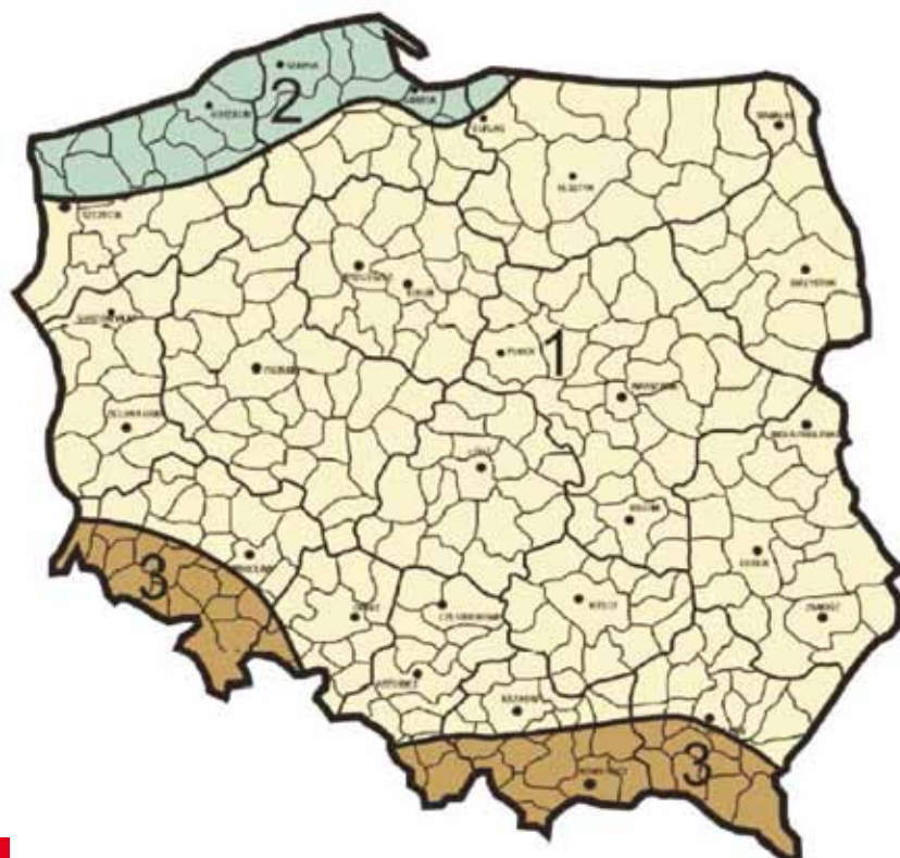
Rys. 1. Podział Polski na strefy obciążenia wiatrem
